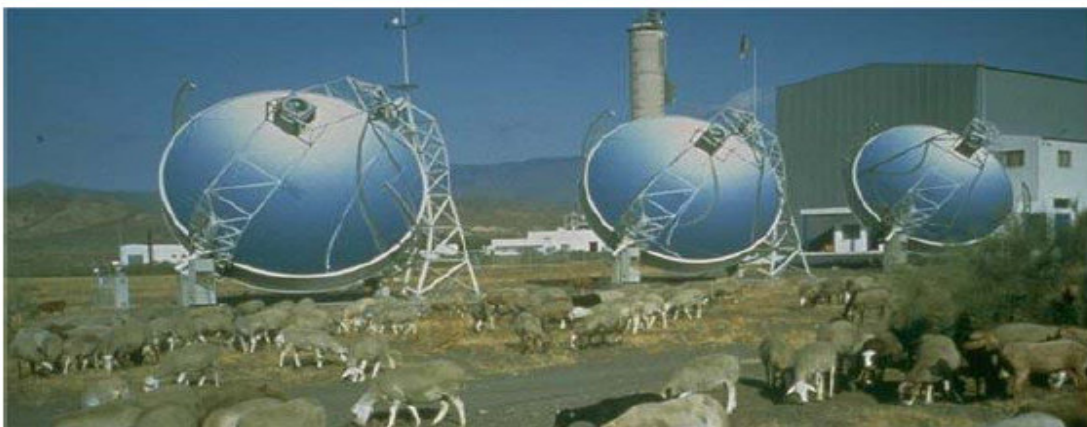
Figura 5 – Serie di concentratori parabolici presso piattaforma solare di Almeria.
