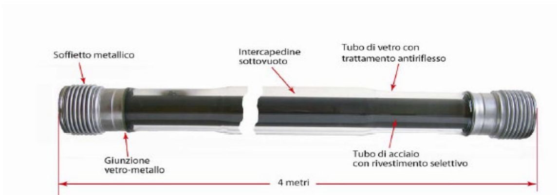
Figura 14 – Il tubo ricevitore di un collettore parabolico lineare.
